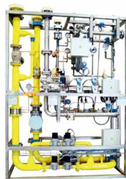
Esempio di skid di alimentazione oxy fuel.
