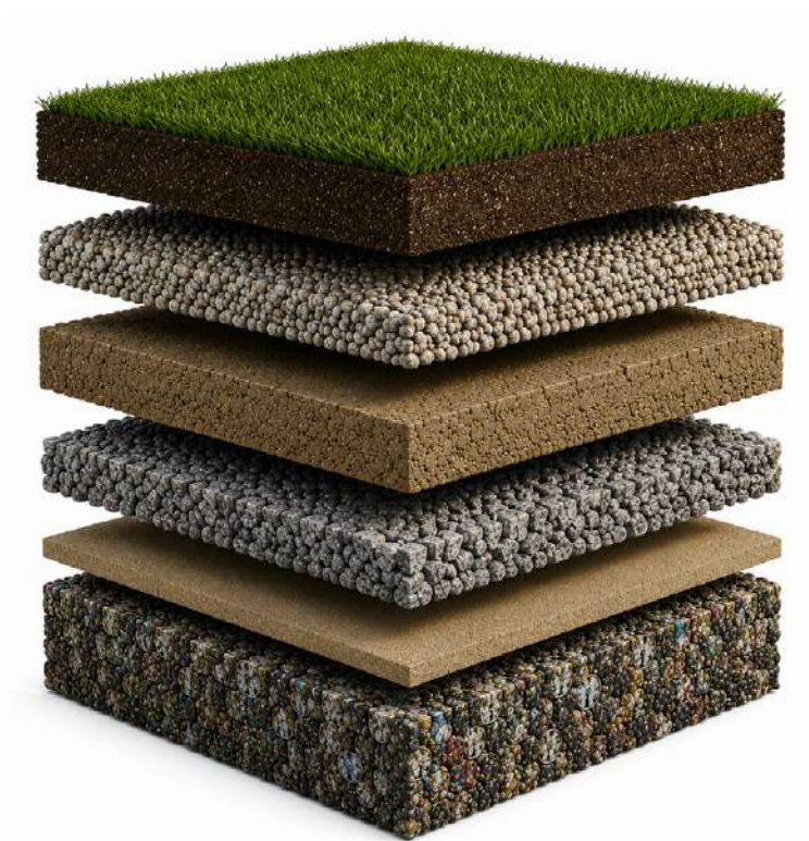
Stratigrafia di una discarica di rifiuti non pericolosi costruita in modo tradizionale.
